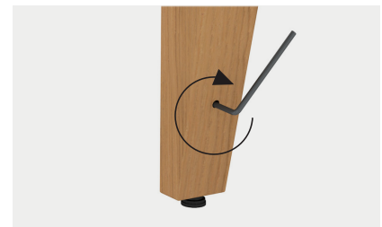
Pieds en bois massif avec vis de réglage; plage de réglage 20 mm.
